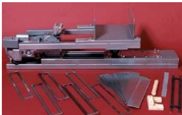
Figura 779 - 2. Máquina y accesorios para el ensayo de rueda cargada
