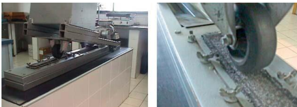
Figura 779 - 4. Rueda actuando sobre la capa de arena
